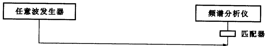
图 11 任意波发生器正弦信号失真特性校准连线框图
