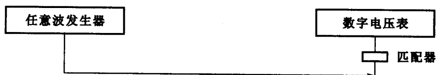
图 3 任意波发生器静态特性校准连线框图
