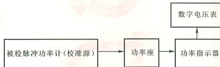
图 6 功率计校准源的输出功率电平检定框图
