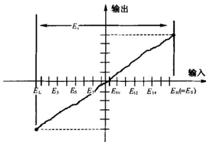
图 7 数字存储示波器输入输出特性
