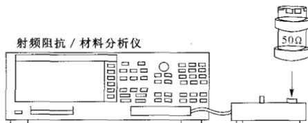
图7 “50Ω负载”阻抗测量示值的校准
